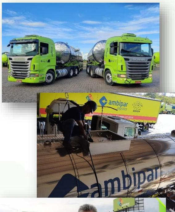
**Ações:** Negociação com o cliente para uso de equipamentos dedicados a transportar sempre o mesmo produto químico, diminuindo as lavagens entre o transporte, mantendo traços do produto do carregamento anterior. Limpeza com uso de nitrogênio para proteção do tanque e diminuição do consumo de água; Maior agilidade nas operações com economia de recursos hídricos e redução dos efluentes líquidos.
